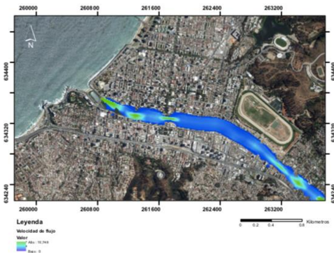
Figura VI. Modelo cinemático basado en el modelo de inundación previamente generado, donde se pueden identificar al menos 4 zonas que experimentarían aumento en la velocidad de transporte del flujo. Fuente: elaboración propia.
