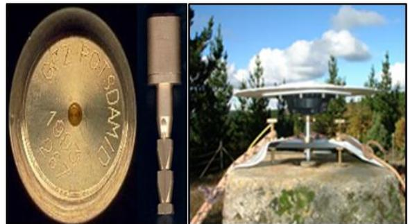
Imagen 22. Placa tipo SAGA empotrada y antena atornillada directamente sobre base, que era nivelada directamente sobre el punto. Fuente: Sección Geodésica, IGM.
