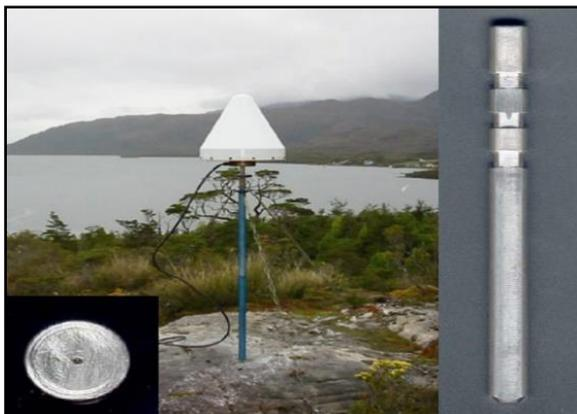
Imagen 20. Anclaje Tech 2000 con antena Choke Ring y pin utilizado por CAP, el que se empotraba en roca madre a ras de suelo. Fuente: Sección Geodésica, IGM.
