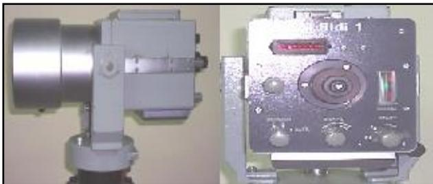
Imagen 12. Distanciómetro ELDI 1, medida 5 km. con prismas TR16. Fuente: Sección Geodésica, IGM.
