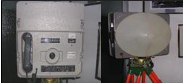
Imagen 11. Distanciómetro SIAL, la distancia de medición llegaba a los 40 km. Fuente: Sección Geodésica, IGM.
