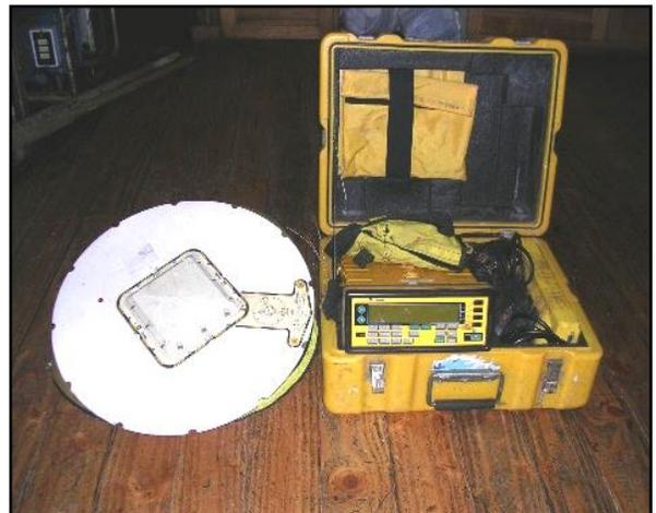
Imagen 23. Equipo Trimble 4000 SSI con Antena Doble Frecuencia Ground Plane utilizado por el proyecto SAGA. Fuente: Sección Geodésica, IGM.
