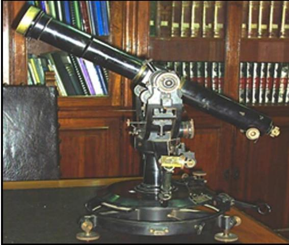
Imagen 6. Teodolito azimutal "Max Hildebrandt" Utilizados para triangulaciones entre 1920 y 1940. Fuente. Sección Geodésica, IGM
