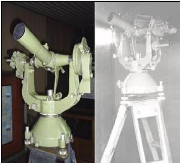
Imagen 7. Teodolito Wild T4. Fuente: Mapoteca - Sección Geodésica, IGM.
