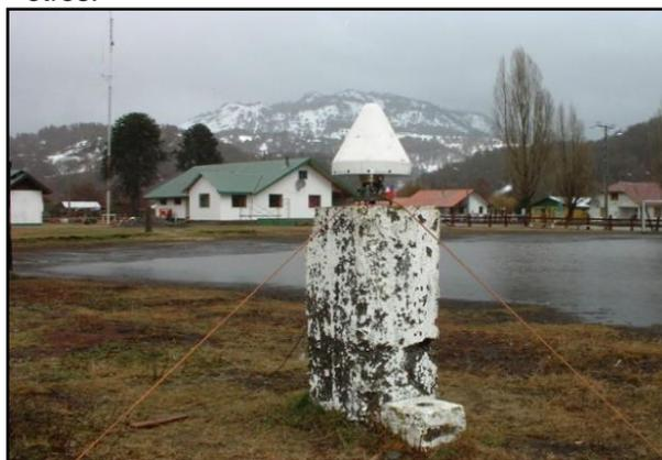
Imagen 26. Pilar de la antigua red trigonométrica medido con GNSS en las campañas de medición, para la obtención de parámetros de transformación entre Datum locales y SIRGAS. Fuente: Sección Geodésica, IGM.
