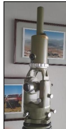
Imagen 9. Giroscopio Wild T16, utilizado para determinar el norte verdadero entre los años 1975 al 1980. Fuente: Sección Geodésica, IGM.
