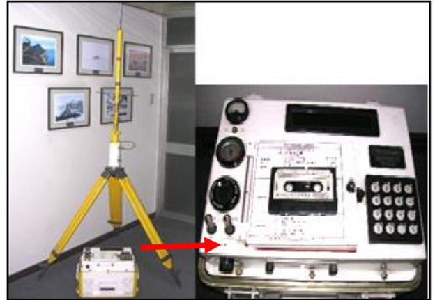
Imagen 17. Georreceptor Magnavox 1502, consistía en un receptor/procesador de 19 kg y una antena preamplificadora de 7.7 kg, la que recibía señales del Sistema satelital TRANSIT. Fuente: Sección Geodésica.
