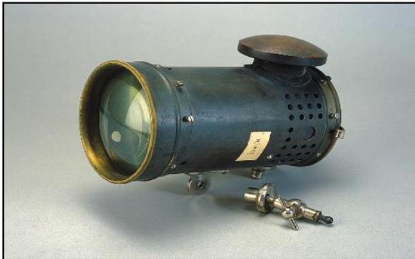
Imagen 16. Lámpara utilizada para señalar vértices geodésicos en trabajos nocturnos. Fuente: Sección Geodésica, IGM.
