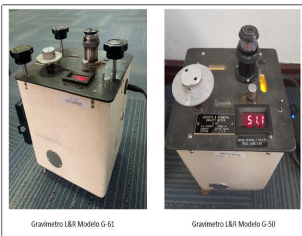
Imagen 1: Muestra gravímetros L&R modelo G-61 y G-50 utilizados por el IGM. Fuente: Sección Geodésica, IGM.
